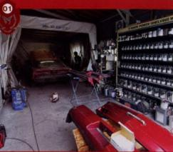
(1)(2)(3)(4)(5)(6)(7) フロント及びリアフェイシアを外された状態で下処理を進められるGTA。前回お伝えしたように、その表面は黒が剥離しているいたりクリアの剥離でいたりして、見るからにポンボツというムードを醸し出していた。しかし、鉄板自体に深刻な腐蝕ではなく、塗装がヒビ割れして剝離を喫するコンディションと言ふわけでもない。つまり、リペイントのベースとしては非常に優秀な状態であり、特に苦労することもなく作業を進行できそうである。
