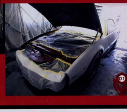
※13 目的の塗料、カラーを正確に塗布する。すでにGTAはプライマーが吹かれ、その表面を仕上げた状態になった。今回のリペイントでは、フロントとリアのローワーフェイスは、ホワイトカー、サイドスカート、そしてリアゲートと、塗装する面積が広い。その部分の塗料の付着性を向上させるために、特製の下塗りペーストを使用する。このペーストは、塗料の付着性を向上させるために使用される。また、この工程では、車体の表面を滑らかにし、塗料の付着性を向上させるために行われる。
