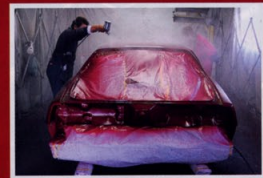
※14 まずは下塗りから、これは最終的な色の乗りをよくなるためのプロセッサが、これにより下塗り工程が完了する。その後、本塗料の塗布が行われる。この工程では、車体の表面を滑らかにし、塗料の付着性を向上させるために行われる。
